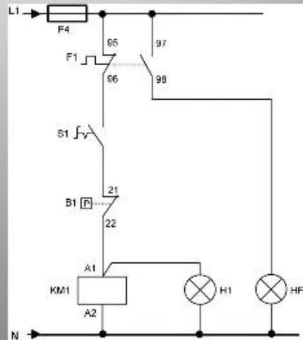
Esquema de conexión para motobomba de agua trifásica mediante presostato.
