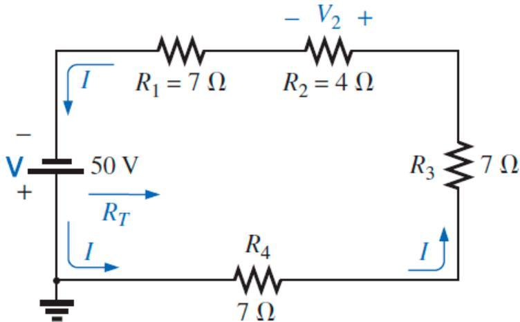
Determine la resistencia total, la corriente del circuito y el voltaje en la resistencia dos.
