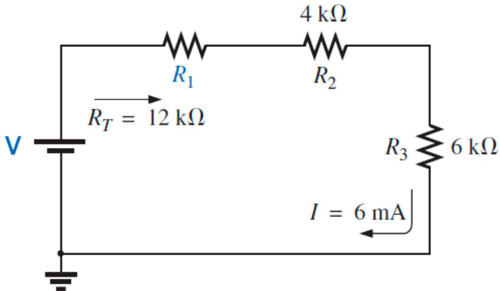
Dadas la resistencia total del circuito y la corriente, calcule el valor de R1 y el valor de la fuente de tensión.
