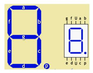
Es un dispositivo que en su interior contiene 8 diodos leds organizados de tal manera que con el display se pueden formar números y letras dependiendo de su configuración: ánodo o cátodo común.
