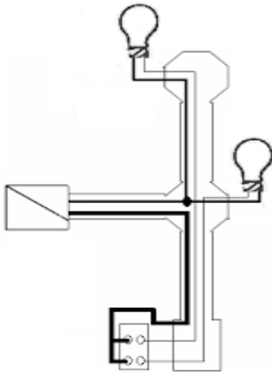
**ESQUEMA: 2 conexión de 3 puntos de luz desde interruptor triple.**
