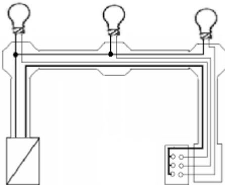
**ESQUEMA: 3 conexión de 1 punto de luz desde 2 interruptores conmutables.**
