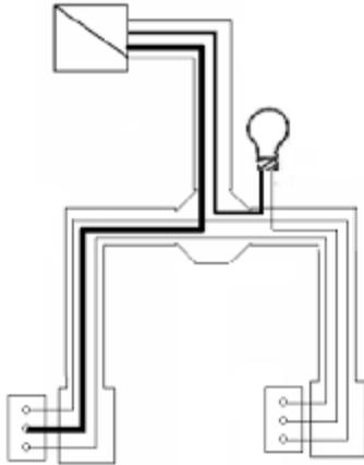
**ESQUEMA: 4 conexión de 1 punto de luz desde 3 puntos.**
