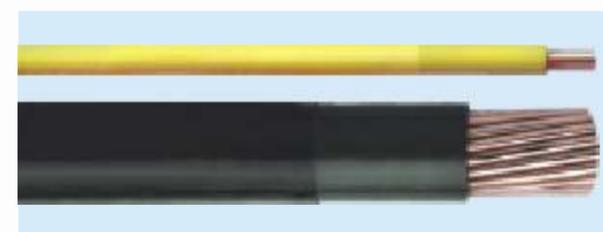
La norma NTC 2050 artículo 310-3 indica que cuando los conductores van instalados en canalizaciones, los calibres iguales o mayores a 8 AWG deben ser cableados (conductores compuestos de varios hilos).
