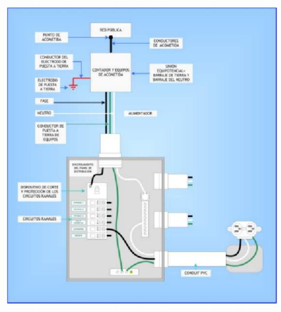
Figura 3. Ejemplo de conexiones para circuitos ramales.
