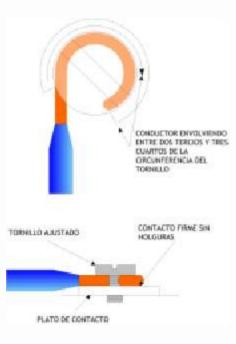
Figura 6. Conexión correcta.
