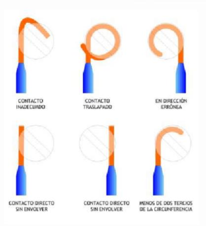
Figura 7. Conexión incorrecta
