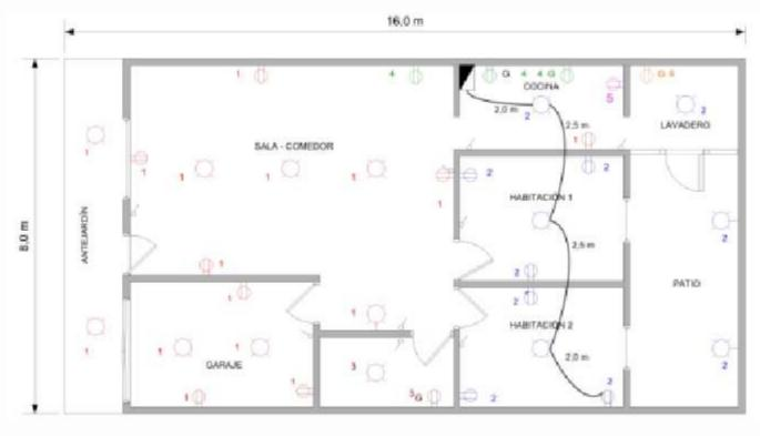
Figura 4. Plano con los circuitos eléctricos, ejemplo de canalizaciones y símbolos utilizados.
